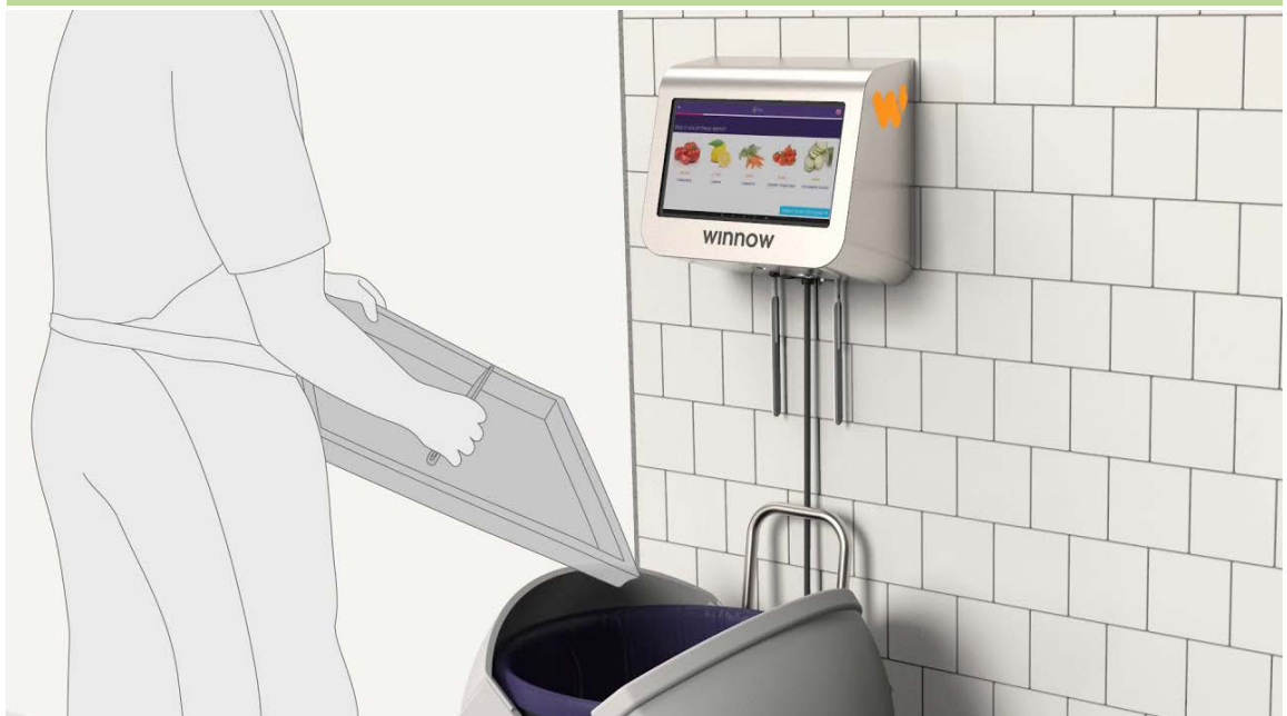
Afbeelding 4. Schematische weergave van Winnow Vision: het voedselafval wordt gewogen en geïdentificeerd
